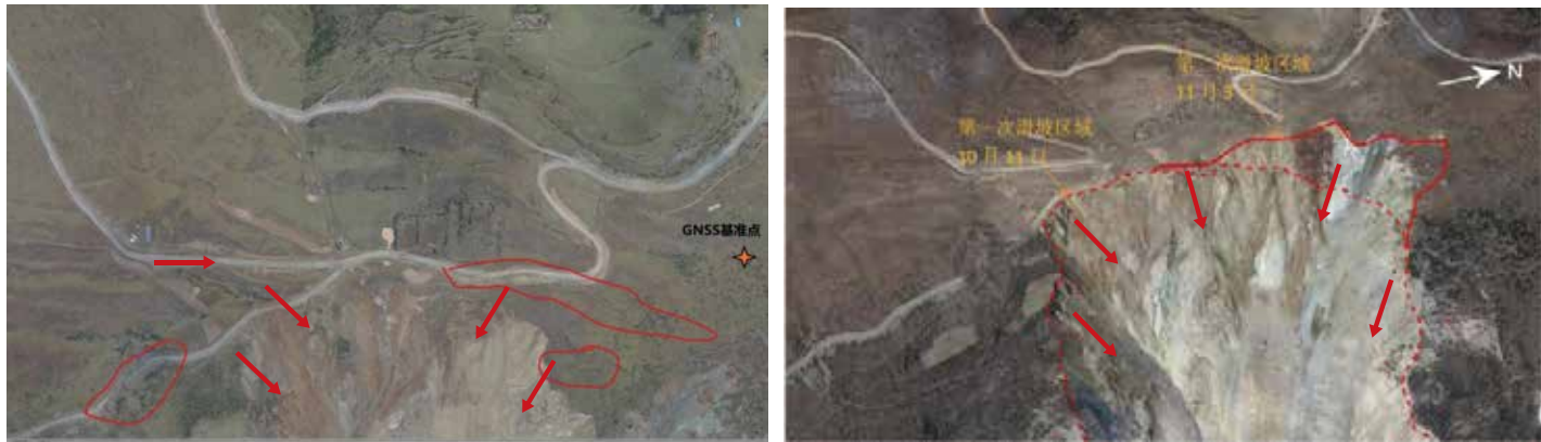
第一次滑坡宏观位移方向和第二次滑坡宏观位移方向对比
